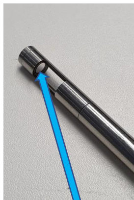
Ponta da sonda com ótica reflectiva
