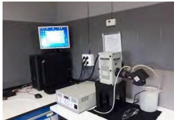
1. **Espectrorradiómetro de doble monocromador** MACAM UV-Vis- Infrarrojo cercano (180-1700 nm) para medidas de irradiancia de artificial y solar y medidas de radiancia para el cálculo de riesgo fotobiológico en fuentes de luz
