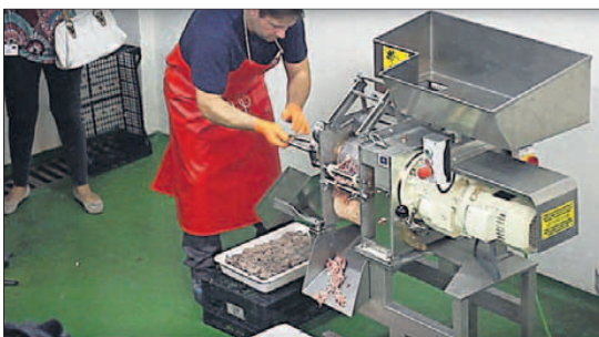
En la planta piloto de Marín se separó el músculo (izquierda) con el que se elaboraron bloques de pasta de pescado congelados (derecha).
